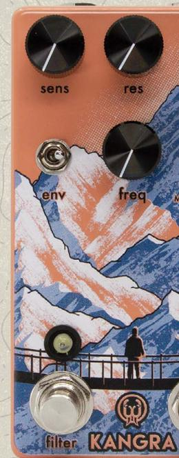
**FREQ**: establece la frecuencia de corte del filtro. Utiliza este control para dar forma a la señal de fuzz y/o señales de otros pedales que tengas en tu cadena de efectos para crear sonidos de filtro únicos. Este control combinado con el de resonancia puede producir muchos sonidos filtrados con mucha personalidad.
