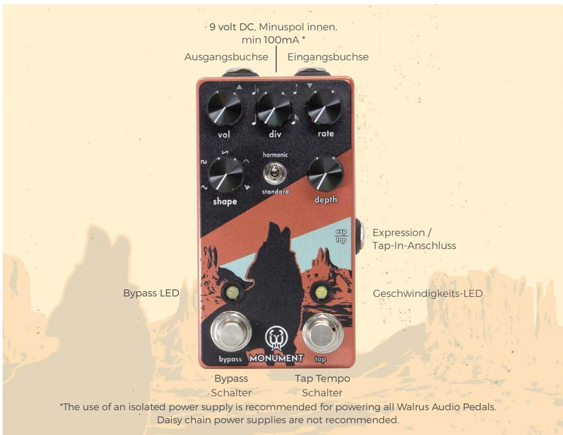
**VOLUME** - Regelt den Ausgangspegel. Wenn der Depth-Regler auf 0 steht und der Ausgangspegel über Unity Gain, erzeugt der Monument einen sauberen Boost.
