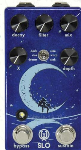
ALGORITHM-SCHALTER – Mit dem Schalter wird einer von drei verfügbaren Hall-Algorithmen ausgewählt. **Zweite Funktion:** Auswahl der Wellenform zur Modulation.
