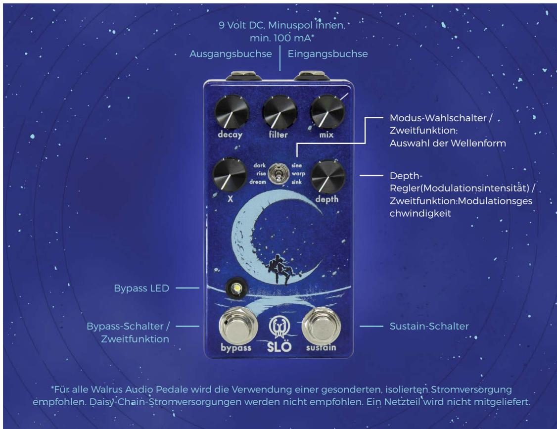
**DECAY** - Regelt die Abklingzeit des Reverbs. Ganz nach links gedreht erhältst du einen kurzen, tighten Hall. Drehe den Regler im Uhrzeigersinn, um die Nachhallzeit zu verlängern.
