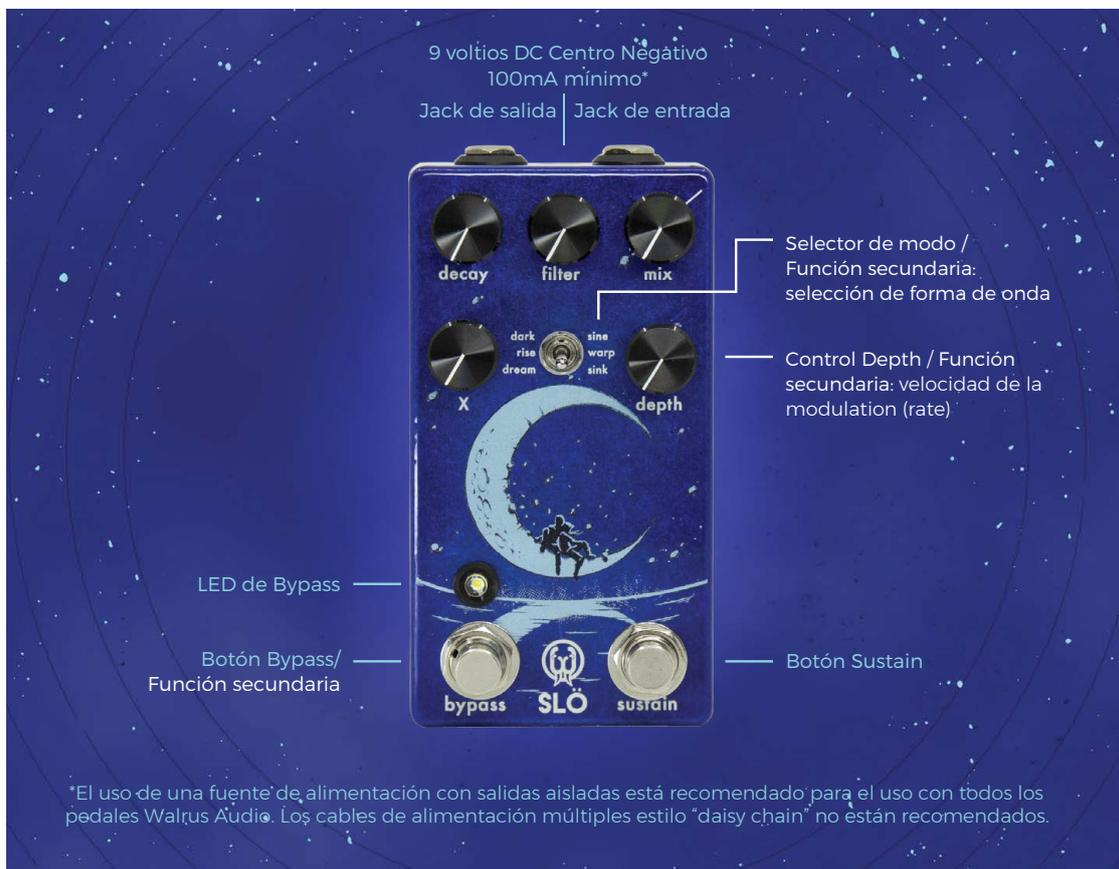
**DECAY** - Ajusta la duración del decaimiento de la reverberación. Es posible ir desde una reverb corta y seca con el control totalmente en sentido antihorario, a una larga textura al ponerlo al máximo en sentido horario.
