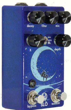
**FUNCIONES SECUNDARIAS** - Para acceder a las funciones secundarias, con el pedal activado, mantener presionado el botón de bypass y usar el selector para escoger la forma de onda deseada, y el control Depth para ajustar la velocidad de la modulación. El pedal recuerda la forma de onda escogida y la velocidad para el algoritmo activo en ese instante hasta la próxima vez que es modificado. El pedal también mantiene el algoritmo y el ajuste de Depth cuando se modifican funciones secundarias.
