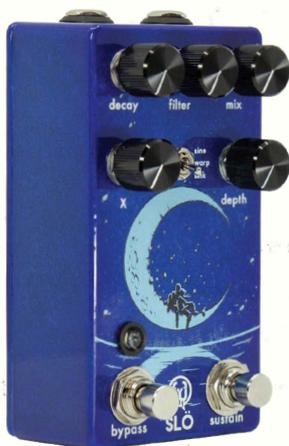
**FONCTIONS SECONDAIRES** - Pour accéder aux fonctions secondaires, lorsque la pédale est allumée, maintenez le bouton de Bypass enfoncé et utilisez le sélecteur pour choisir la forme d'onde, et le bouton Depth pour régler le taux souhaité. La pédale garde en mémoire la forme d'onde et le réglage de taux de cet algorithme jusqu'à ce qu'ils soient modifiés. La pédale conserve également l'algorithme et le réglage de profondeur lorsque les fonctions secondaires sont modifiées.
